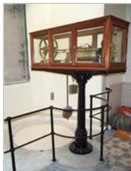
maregraf mecanic cu flotor (Brest, Franța)
