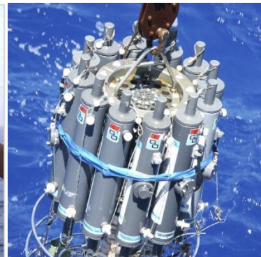
serie de batometre pentru diferite adâncimi (foto: livejournal.com )
