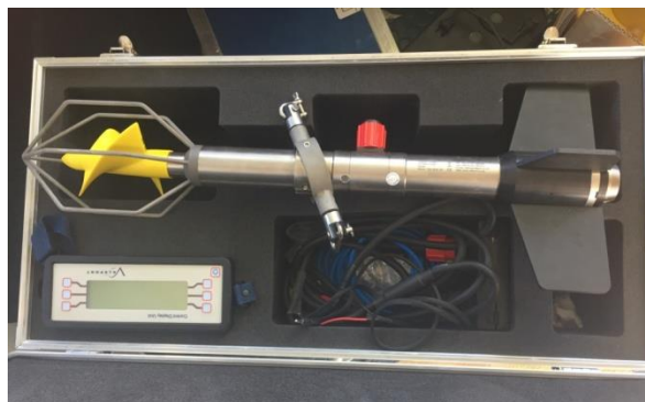
Figura 3.3.6. Curentometru marin Valeport - Modelul 106
